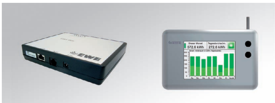
Abbildung 2 EWE-Box IP-basiertes Smart-Metering- System mit Feed Back System
