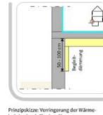
Prinzipkizze: Verringerung der Wärmebrücke durch Flankendämmung
