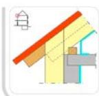
**Prinzipdarstellung: Anschluss Zwischensparrendämmung zur Außenwanddämmung**
